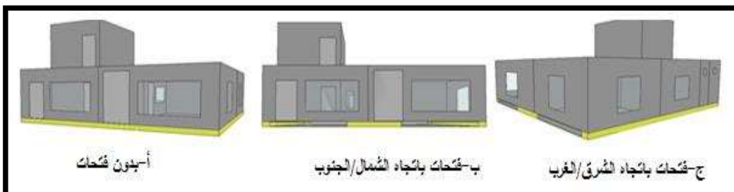
شكل (8): - طريقة رفع الارضية المزدوجة لتكوين الحيز الهوائي السفلي وبالحالتين المغلقة والمفتوحة وبالطريقتين الجنوب/الشمال و الشرق/الغرب لتوجيه الفتحات.
